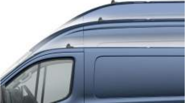
WYSOKI DACH - H3 Wyposażenie standardowe wersji L4. Opcja dla pozostałych wersji.
