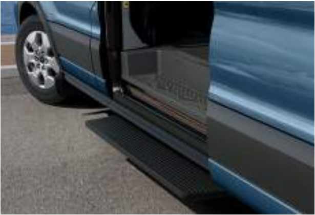
STOPIEŃ BOCZNY WYSUWANY ELEKTRYCZNIE Opcja dla wersji VAN 350 L3 z napędem RWD
